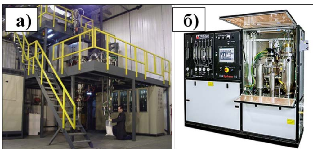
Рис. 9 ВЧ плазменные установки сфероидизации порошковых материалов Текна мощностью 400 кВт (А) и 15 кВт (Б) [170, 171]
