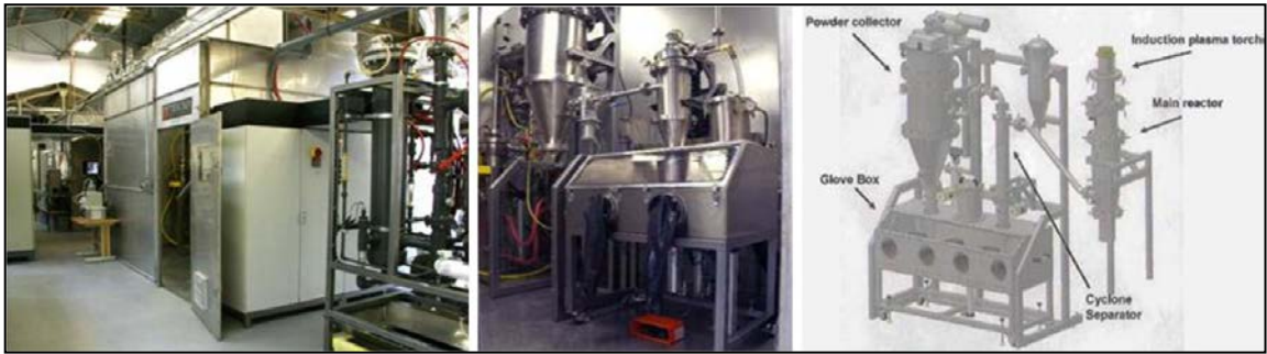
Рис. 5 Общий вид плазмохимической установки получения нанопорошков в ARDEC DoD [92, 93]
