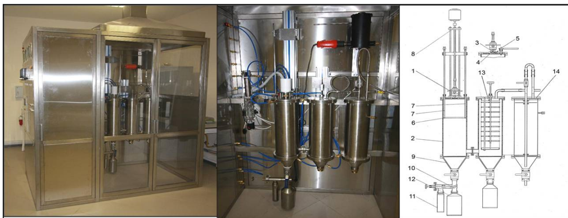
Рис. 8 Плазмохимическая установка ИМЕТ РАН на базе электродугового плазмотрона мощностью 25 кВт [112-114]
